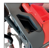
Réservoir d'eau propre
