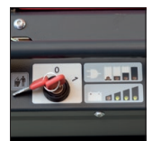
Affichage du niveau de charge de la batterie et du chargeur intégré
