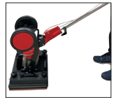
Retourner le timon pour obtenir un poids max. sur le sol
