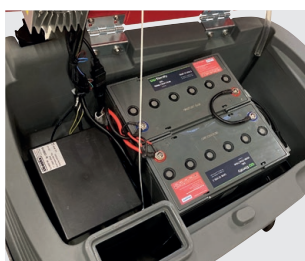
Machine ouverte avec batteries
